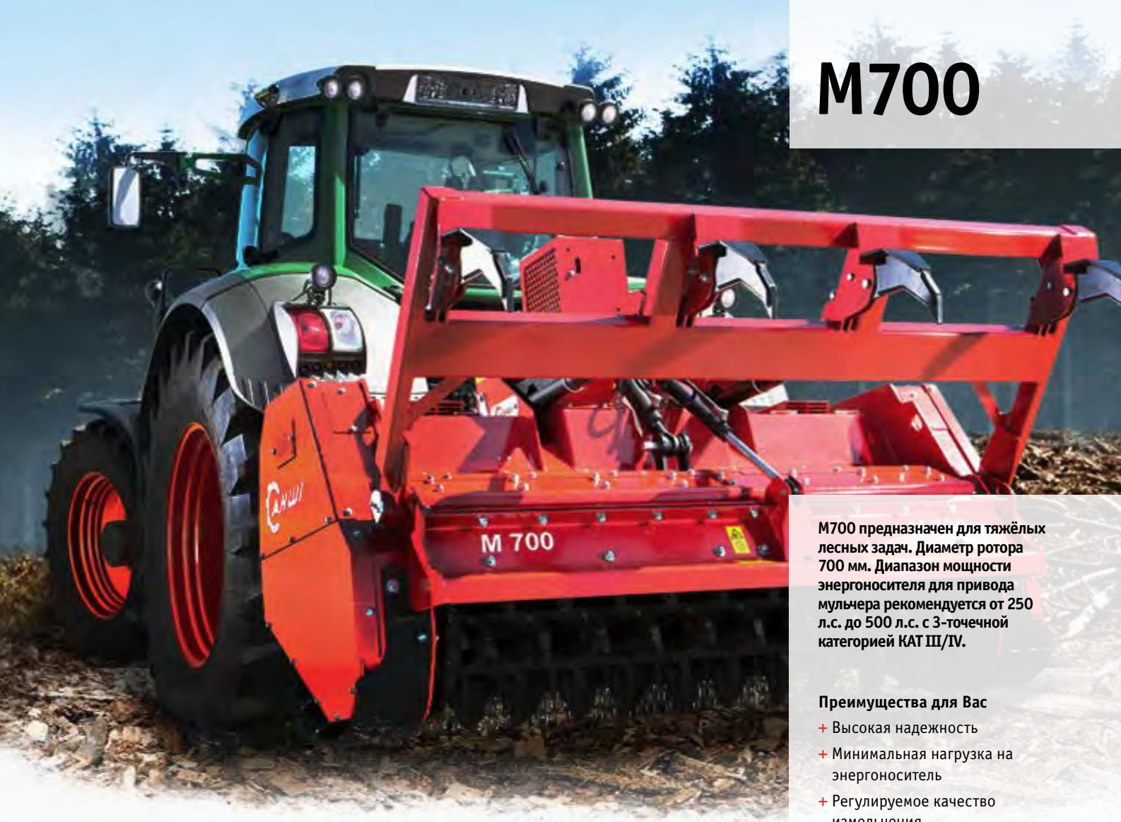
M700 предназначен для тяжёлых лесных задач. Диаметр ротора 700 мм. Диапазон мощности энергоносителя для привода мульчера рекомендуется от 250 л.с. до 500 л.с. с 3-точечной категорией КАТ III/IV.
