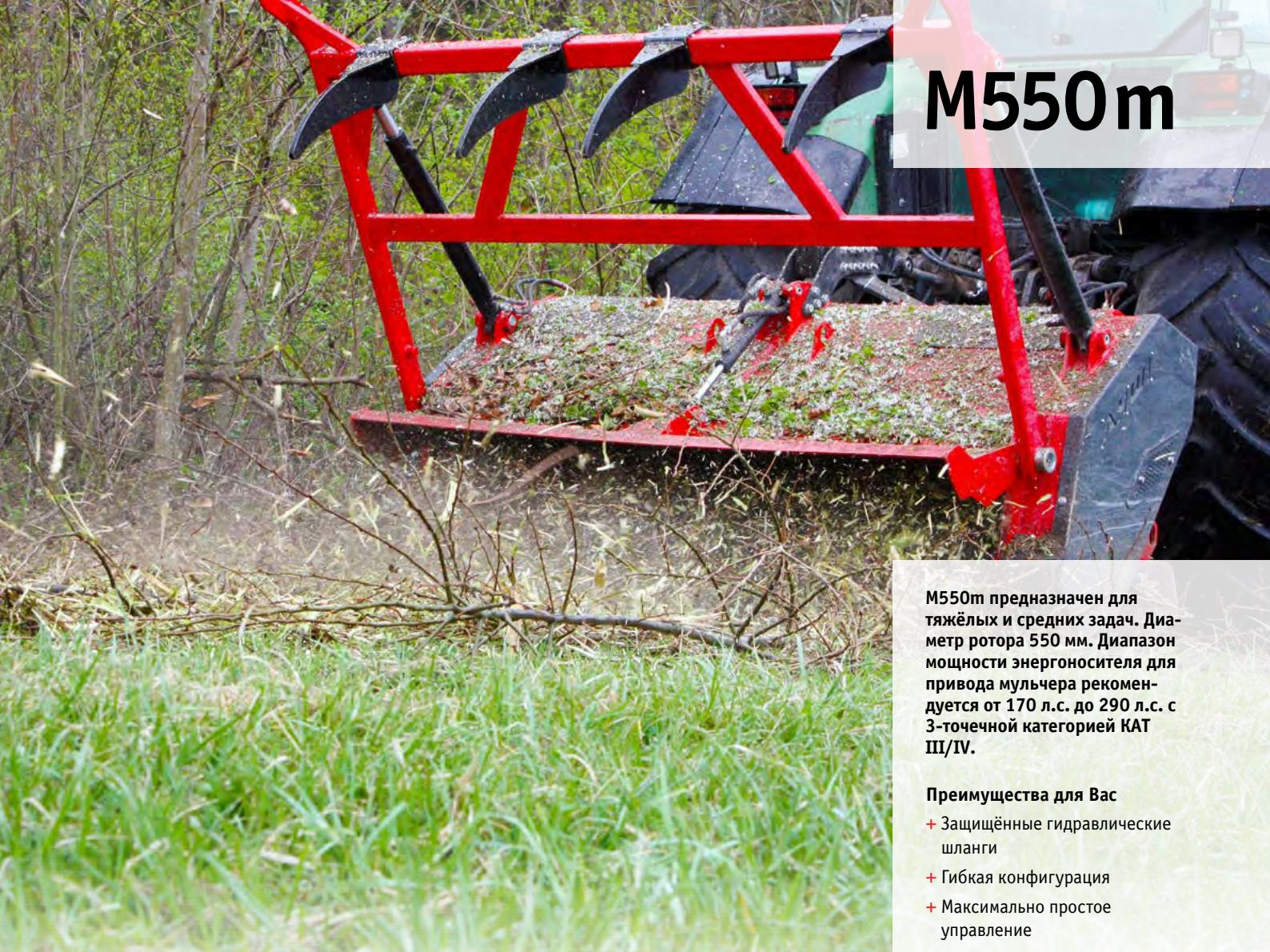
M550m предназначен для тяжёлых и средних задач. Диаметр ротора 550 мм. Диапазон мощности энергоносителя для привода мульчера рекомендуется от 170 л.с. до 290 л.с. с 3-точечной категорией КАТ III/IV.
