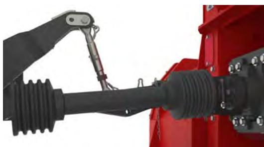
Данная W-Кинематика привода позволяет работать карданныму валу всегда в максимально - горизонтальном положении, несмотря на рабочий угол.
